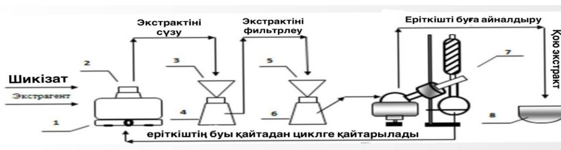
Сурет 25 - Xanthium strumarium L. қою экстрактысын өндірудің аппараттық схемасы.
